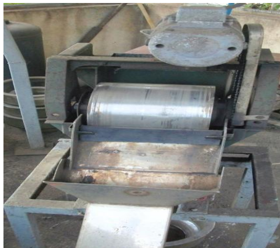
Figura 2.2 Separador magnético de tambor por vía humedades baja intensidad WD-WADR-190 X 150 (LXD en mm)
