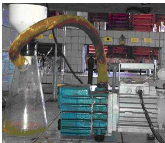
Figura 2.8 Bomba de vacío para el filtrado de la pulpa lixiviada
